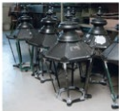
denkmalgerechte Instandsetzung von Laternenhäuben
