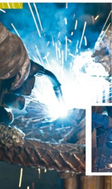
Reparatur Bohrkopf, neuer Besatz des Erdreichbohrers mit Industriediamanten und Riffelstruktur
