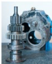
Reparatur Getriebe, Anfertigung und Austausch der Zahnräder und Lager
